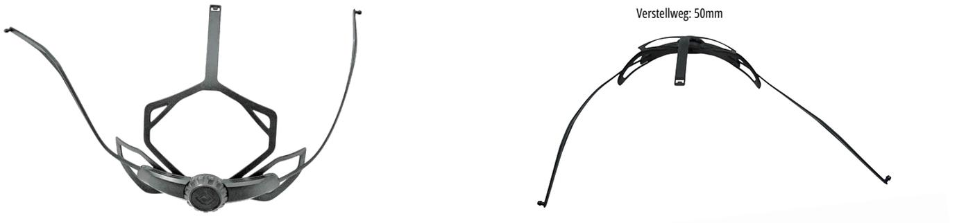
Die 3-Punkt-Ausführung wird an zwei Haltepunkten seitlich im Helm eingeklickt. Ein Rasterband an der Kopfspinne, verbunden mit einem Anker im EPS, ermöglicht eine individuelle Höhenverstellung, sodass die Kopfspinne optimal an die Kopfform angepasst werden kann.
